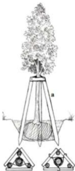
Obr. 5: Kotvení stromu s balem
